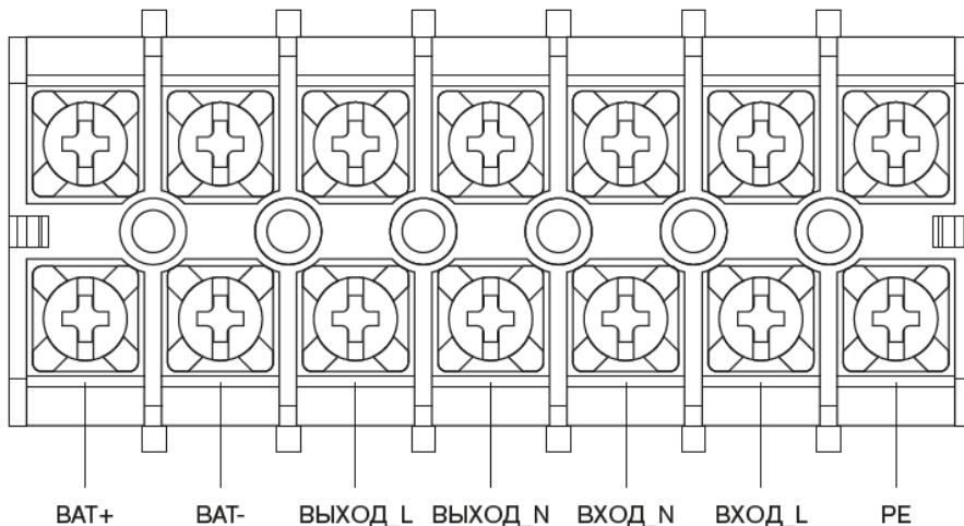
4. Сечение защитного заземляющего провода должно быть такого же сечения как входной. Для заземления используйте желто-зеленый провод.
