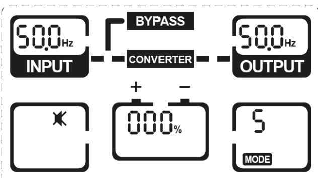
Входная частота: 50Hz
