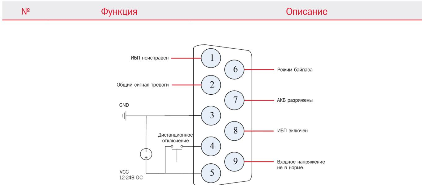
Рис. 9-1 Схема подключения сухих контактов
