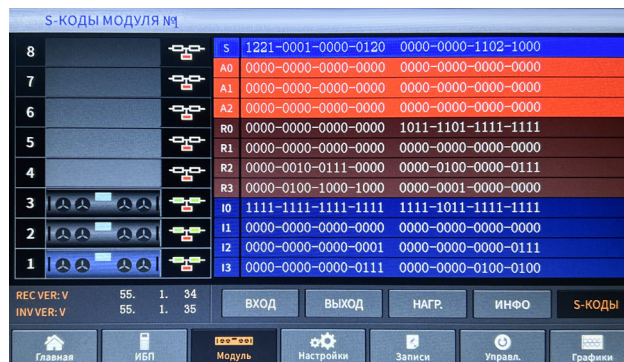
4. S-коды силового модуля
