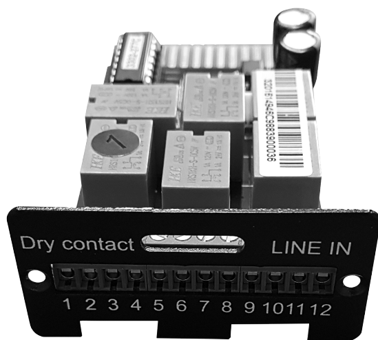
Рис. 20 Внешний вид карты сухих контактов
