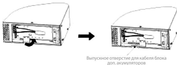
Рис. 9 Снятие направляющих для кабеля
